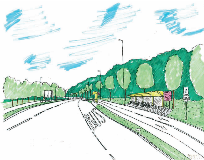
Ureditev avtobusnega postajališča in dvosmerne kolesarske steze ter kolesarnice.
